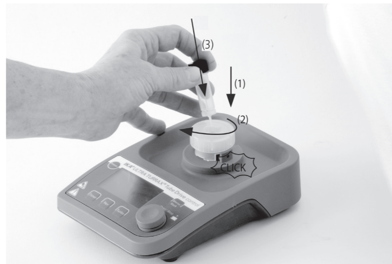
St-2 - Tube aufstecken • Put on the St-2 - Tube • Mettre le St-2 - Tube • Установка пробирки St-2
