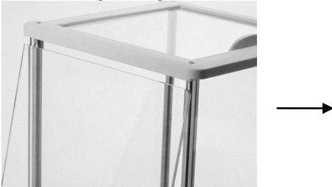
1) Installazione degli sportelli laterali. Inserire completamente nel telaio superiore e poi spingere in basso sul fermo.
