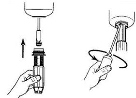
8. Reemplace el cono de la válvula cheque (P170), el sello de la válvula cheque (J051), y la lengüeta de la válvula cheque (P245).
