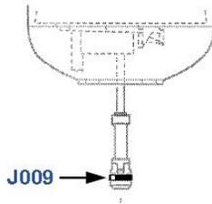
**!** Para remover fácilmente el o-ring sin uso de herramientas, solo oprímalo en ambos lados y este levantará una parte para ser extraído.
